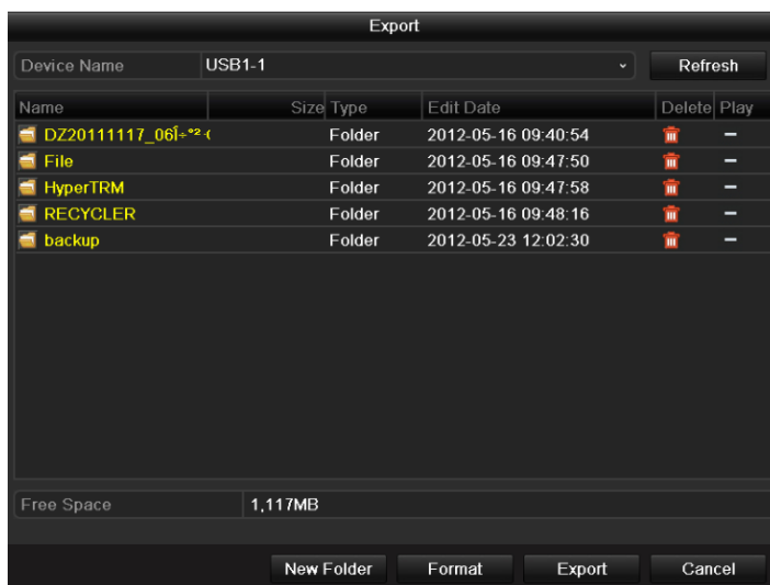
Obr.7.7 Export pomocí Normálního vyhledávání videa použitím USB flash
