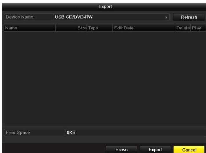
Obr. 7. 8 Export pomocí Normálního vyhledávání videa pomocí USB vypalovacký
