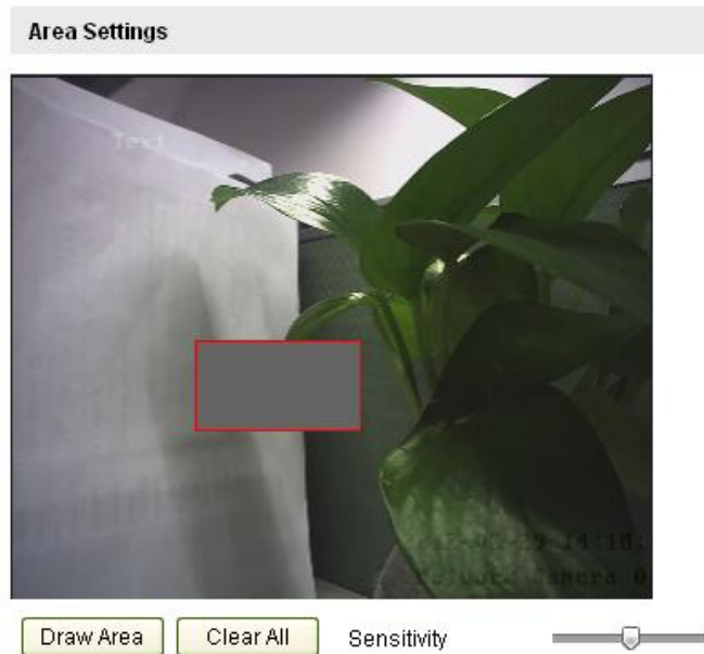
Figure 5-29 Nastavenie alarmu sabotáže kamery
